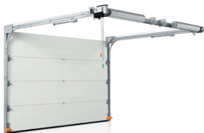
LH – prowadzenie niskie – sprężyny skrętne z tyłu
