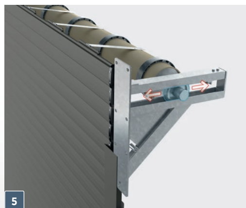
Ruchomy wał – w trakcie nawijania kurtyny zmienia swoje położenie względem ściany nadproża, zapewniając w ten sposób utrzymanie w osi prowadnic poruszającej się kurtyny.
